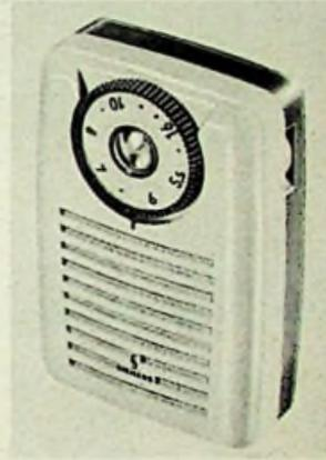
Bild 5. Siemens-Transistor-Taschen-super T 1
